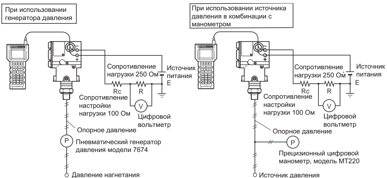
Рисунок 9.3.1. Схемы соединения прибора
